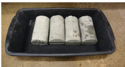
FIGURA 3 – Corpos de prova imersos na solução salina
