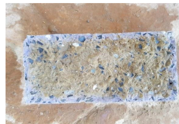
FIGURA 4 - Corpo de prova com pó de mármore após aspersão por nitrato de prata
