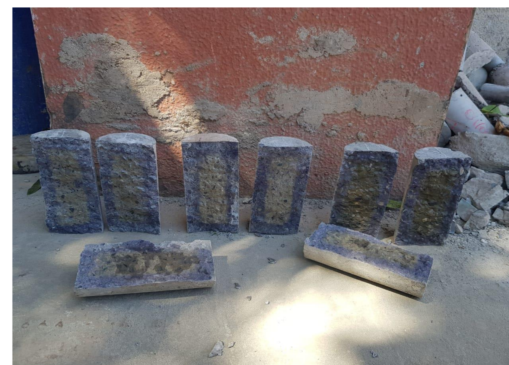
Imagem 3 – Aparência dos corpos de prova após a aspersão do nitrato de prata
