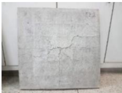
Figura 3 – Placa maciça rompida após ensaio.
