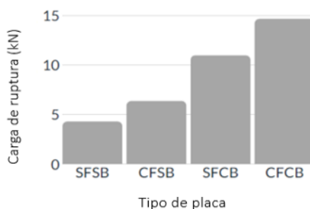
Figura 4 – Carga de ruptura das placas sob flexão das placas maciças.
