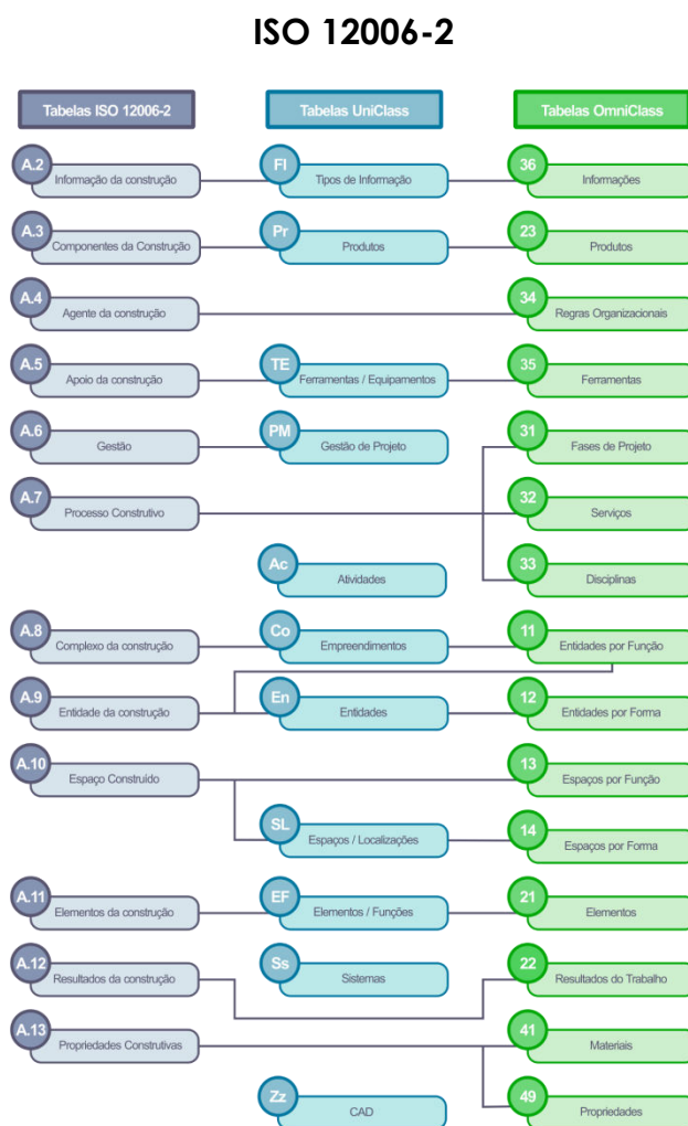
Figura 2 – Correlação entre os sistemas UniClass e OmniClass com base na
