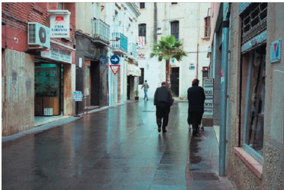
Figura 1 – Eliminação de passeios em vias estreitas
