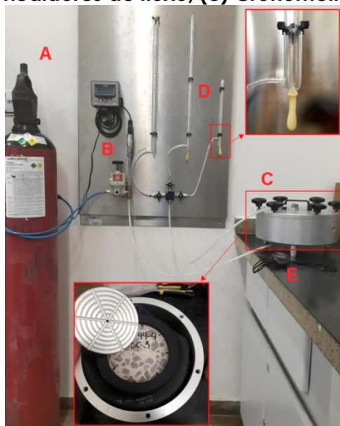
Figura 2 - Permeâmetro Cembureau. (a) Suprimento de gás; (b) Regulador de pressão com manômetro; c) Célula de ensaio com corpo de prova; (d) Medidores de fluxo; (e) Cronômetro
