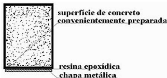
Figura 1 – Reforço em chapas metálicas coladas
