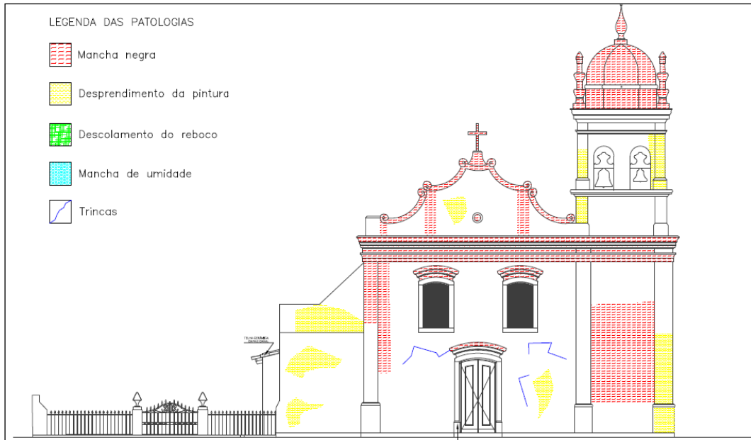
Figura 8 - Mapeamento de Danos da Fachada frontal
