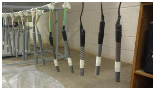
Imagem 3 - Barras de aço após aplicação de epóxi
