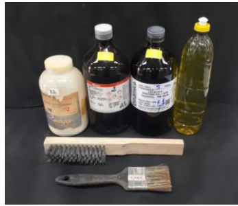
Imagem 1 - Materiais utilizados para limpeza das barras de aço
