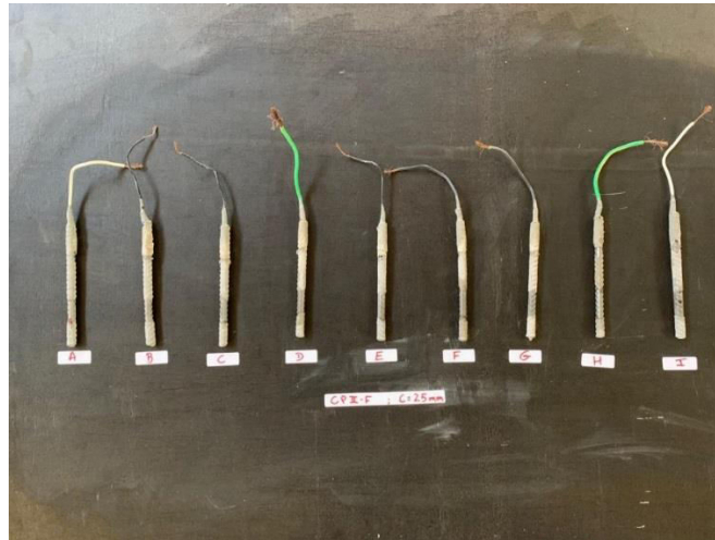
Imagem 8 – barras após o rompimento
