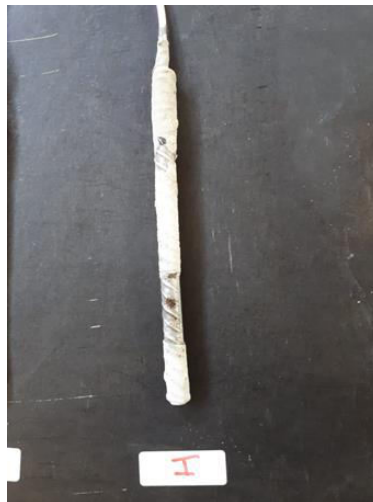
Imagem 9 – Corrosão na barra de aço.
