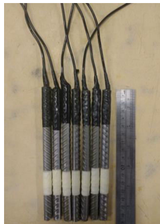
Imagem 2 - Barras antes da aplicação de epóxi
