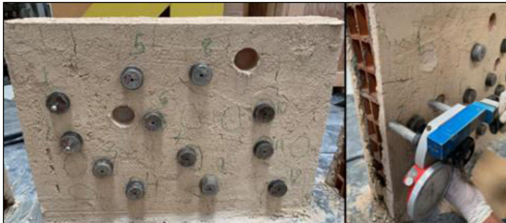
Figura 5 – Ensaio de resistência de aderência superficial
