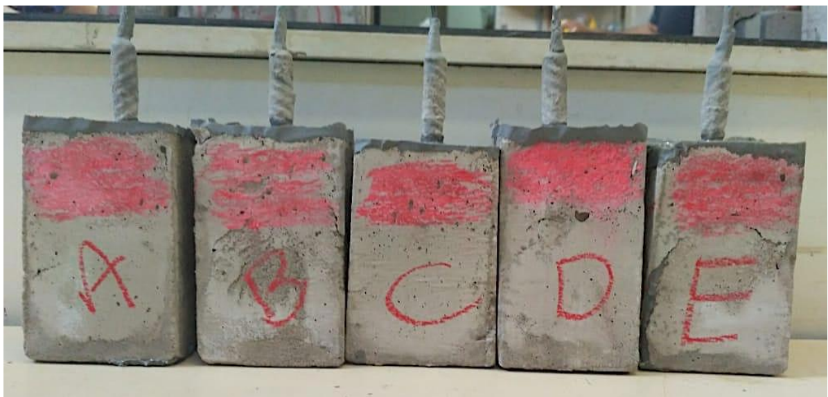
Figura 2 – Corpos de prova prismáticos com cimento CP II - F
