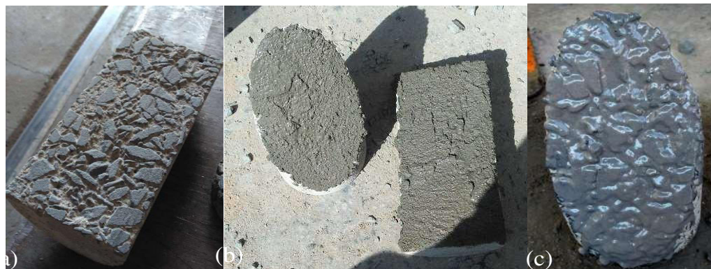
Figura 03 – Corpo de prova após jateamento de areia (a); Superfície com aplicação de argamassa (b) e Corpo de prova após aplicação de resina epóxi.
