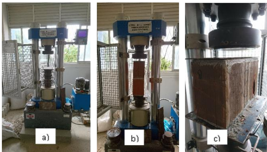
Figura 5 - a) Prensa hidráulica. b) Mostrador digital. c) Prisma cerâmico.
